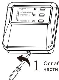
1 Ослабьте винт на нижней части приемника
