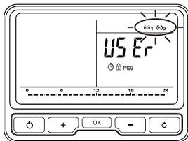
2.2 В интерфейсе сопряжения, нажимайте клавишами **+** или **-** пока не загорится знак **rF2** в левой части экрана, нажмите **OK** для отправки команды на сопряжение шлюзу. Устройства сопряжены успешно, если справа загорится **000**, если не успешно, то загорится E01 или E02 (в случае неудачи повторите отправку команды на сопряжение еще раз, нажав **OK**.)
