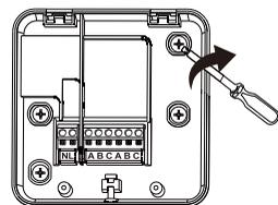
3 Закрепите базу на стене при помощи 4-х винтов (болтов/шурупов)
