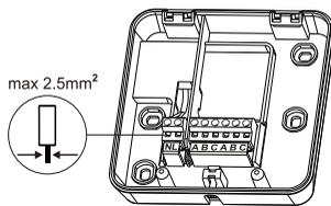
4 Ослабьте винты на клеммах. Правильно подключив базу, зажмите винты
