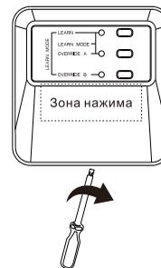
6 Зажмите винт в нижней части приемника после правильной установки крышки и убедившись в правильном подключении
