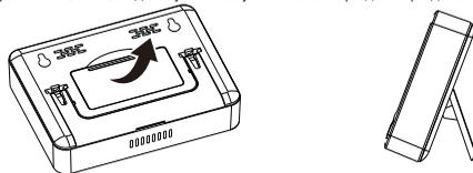
Если Вам необходимо закрепить терморегулятор на стене, то используйте предоставленные размеры для отверстий. Просверлите два отверстия в стене и затяните винты, обеспечивая расстояние 81.5мм между отверстиями; Закрепите заднюю крышку термостата, поместив его на головку винта.
