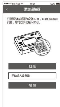
(1-3) 温控器和网关的对码一般需要耗费1分钟，成功后温控器显示屏右上角显示 (i)2 标志，APP页面也会显示已添加的温控器信息。
